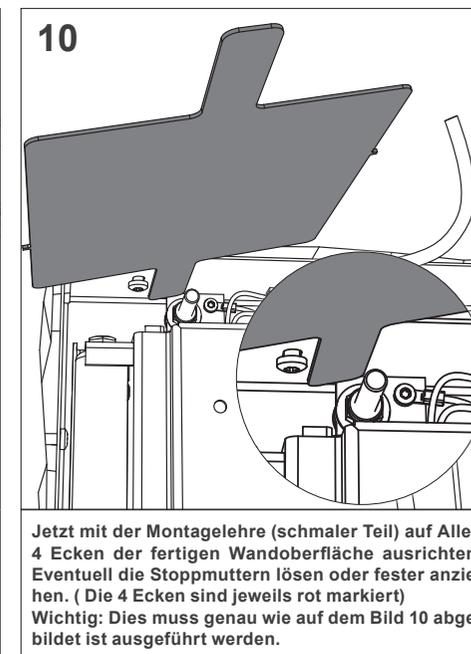
Jetzt mit der Montagelehre (schmäler Teil) auf Allen 4 Ecken der fertigen Wandoberfläche ausrichten. Eventuell die Stopfmutter lösen oder fester anziehen. ( Die 4 Ecken sind jeweils rot markiert) Wichtig: Dies muss genau wie auf dem Bild 10 abgebildet ist ausgeführt werden.
