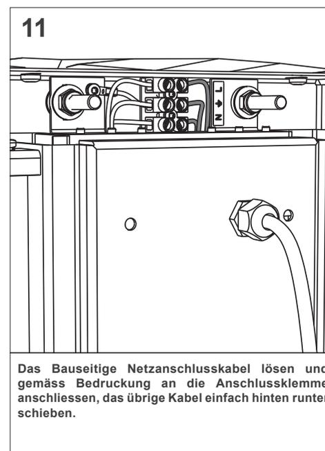
Das Bauseitige Netzanschlusskabel lösen und gemäss Bedruckung an die Anschlussklemme anschliessen, das übrige Kabel einfach hinten runter schieben.
