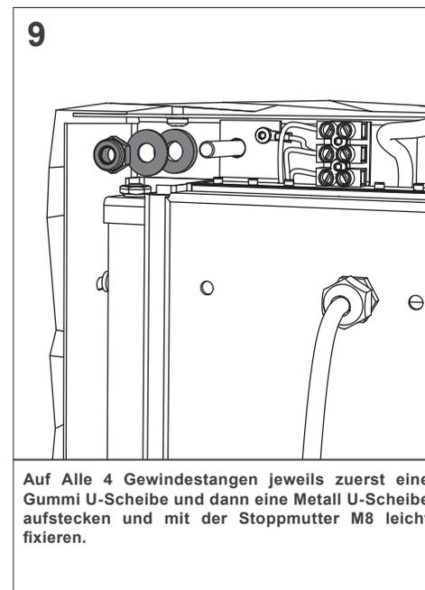
Auf Alle 4 Gewindestangen jeweils zuerst eine Gummi U-Scheibe und dann eine Metall U-Scheibe aufstecken und mit der Stopfmutter M8 leicht fixieren.
