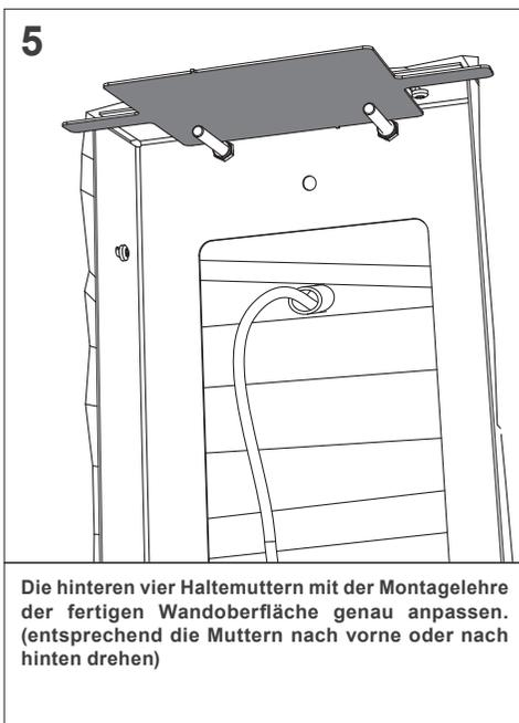
Die hinteren vier Haltemuttern mit der Montagelehre der fertigen Wandoberfläche genau anpassen. (entsprechend die Muttern nach vorne oder nach hinten drehen)
